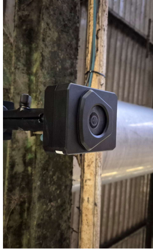
Abbildung 2: Installation der Kamera zur Datengenerierung des Bioabfalls in Vogelperspektive
