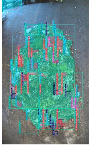
Abbildung 4: Analyseergebnis eines Bioabfallhaufens durch Instance Segmentation der erkennbaren Störstoffe
